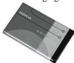
Fig. 22. Lithium – Ion Battery
